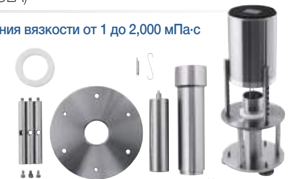
Установка с адаптером для маловязких образцов
